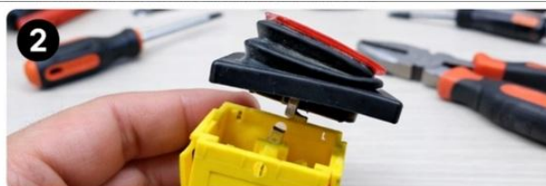
Krok 2: Zdejmij klapkę przełącznika Podważ i zdejmij gumową osłonę z przyciskiem. Uważaj by nie zgubić.
