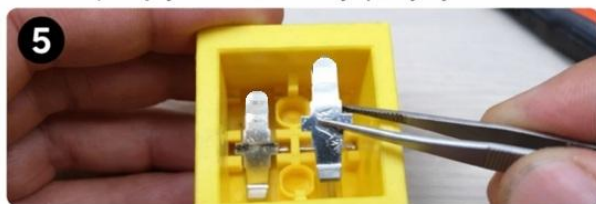
Krok 5: Włóż oczyszczone styki z powrotem Umieść oczyszczone styki w ich oryginalnych miejscach. Upewnij się że dobrze siedzą w zaczepach.
