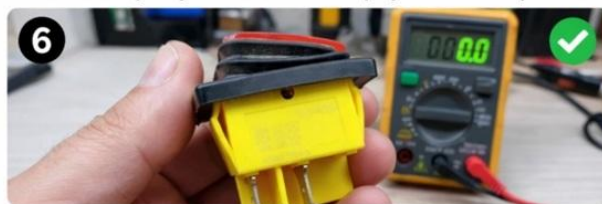
Krok 6: Złóż włącznik i sprawdź działanie Założ gumową osłonę. Zamontuj włącznik. Podłącz zasilanie i przetestuj działanie włącznika.
