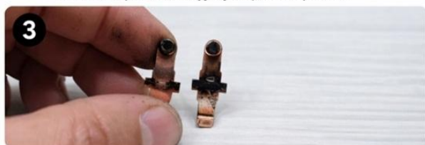
Krok 3: Wyjmij styki Ostrożnie wyjmij oba metalowe styki z obudowy. Zapamiętaj ich ułożenie — lewy i prawy styk.
