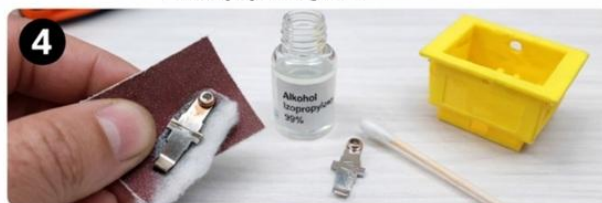
Krok 4: Oczyszcz styki Wyczyść styki papierem ściernym 1000 lub 2000. Następnie przetrzyj wacikiem nasączonym alkoholem IPA do połysku. Usuń okopcenie.
