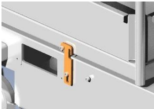
Rys. 2 - Haczyk w pozycji umożliwiającej ruch kosza.
